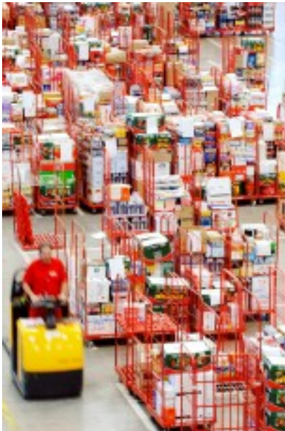
Rollcontainer werden am Warenausgang nach Liefertouren geordnet Quelle: Peter Obenaus, Köln, Lekkerland
